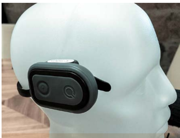
Quaha Zono er en gyroskopisk mus for hodestyring. Det følger med flere alternative bøyler for å feste den på hodet.
