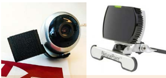
Det finnes flere leverandører av kamerabasert hodemus. Det har sine fordeler at elektronikken står fastmontert.
