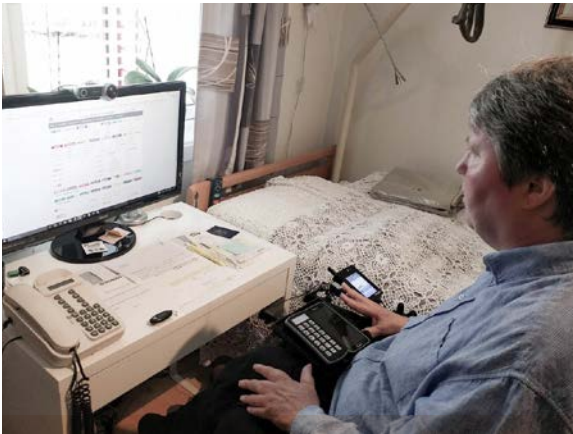
Else Marie viser fram refleksklistermerket sitt i pannen. Det lille kameraet på toppen av datamaskina, registrerer bevegelsene til klistremerket, og beveger musepekeren tilsvarende.
